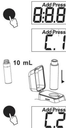
et secouez doucement pendant 2 minutes jusqu'à ce que la poudre soit complètement dissoute. Remplacez la cuvette dans le mètre.
