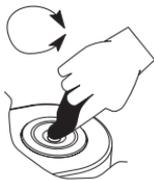
2. Usando una pipetta in plastica far gocciolare il campione sulla superficie del prisma. Riempire completamente la cella di misura.
