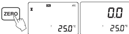
**Nota:** La schermata 0,0 rimane fino a quando viene eseguita la misura di un campione o lo strumento viene spento.
