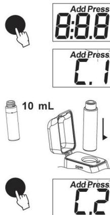
agitare delicatamente per 2 minuti, quindi rimettere la cuvetta nello strumento.
