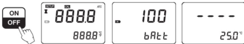
1. Нажмите кнопку ВКЛ/ВЫКЛ (ON/OFF), затем отпустите. Оба дисплея прибора кратковременно отобразят все сегменты. Далее рефрактометр отобразит на короткое время индикатор зарядки элемента питания. После отображения тире на дисплее, прибор готов к работе.
