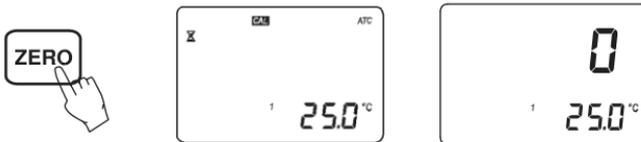
Внимание: Ноль на экране прибора сохранится до выключения прибора.
